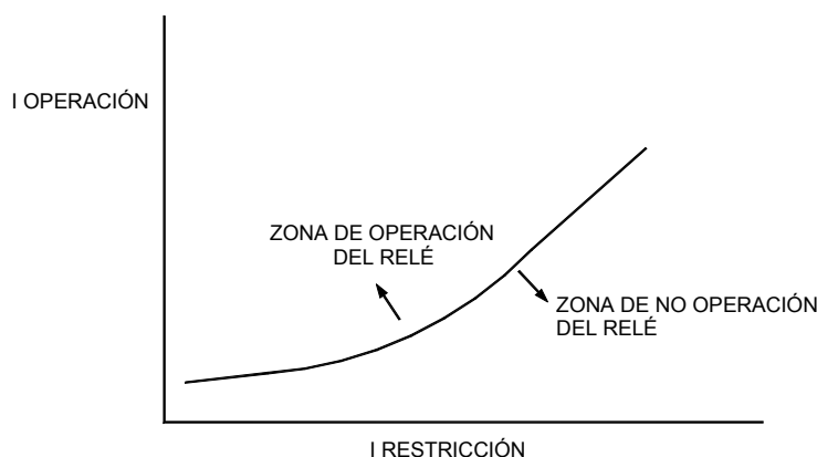
Figura 46 Característica del relé diferencial porcentual
